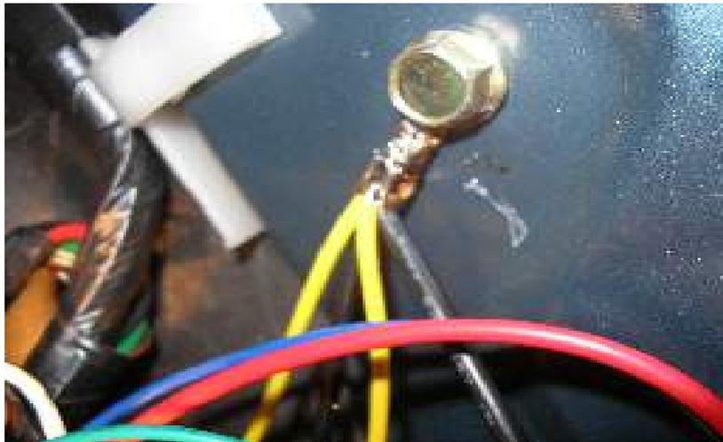
Das war es schon auf der Beifahrerseite. Die beiden violetten Kabel auf die Fahrerseite ziehen zum Blinkrelais (die Fußraum-Verkleidung in der Mitte ist nur gesteckt) . Das Handschuhfach und die Verkleidungen können jetzt wieder ein gebaut werden. Das Blinkrelais ist hinter dem Motorhauben-Öffner (blaues Relais).
