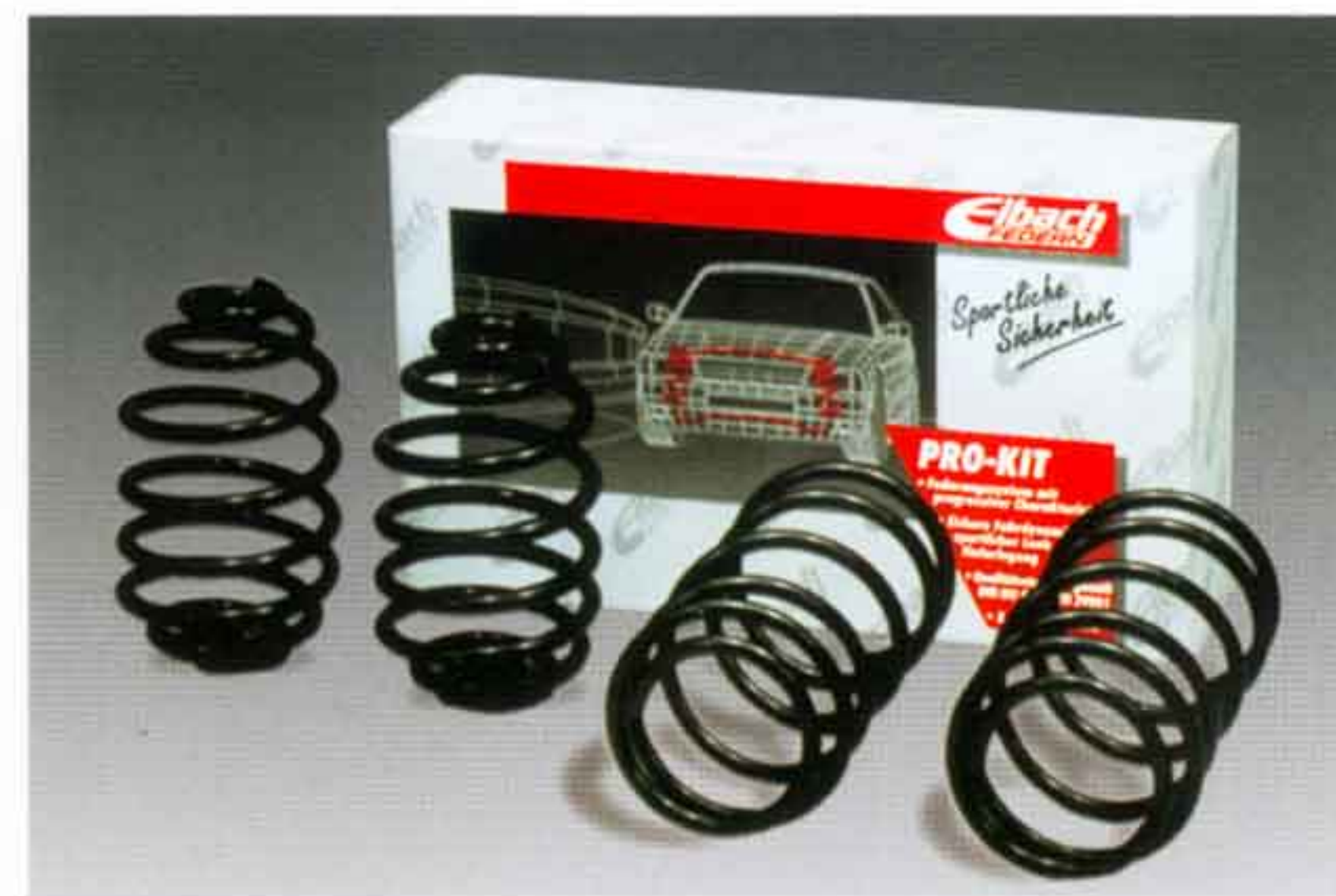
FAHRWERKSFEDERNKIT mit TÜV-Gutachten (1 Satz = 4 Stück) Oberflächenschutz: Kunststoff- beschichtung diamantschwarz, Progressiv-Federn, Tieferlegung des Fahrzeuges: ca. 30 mm
